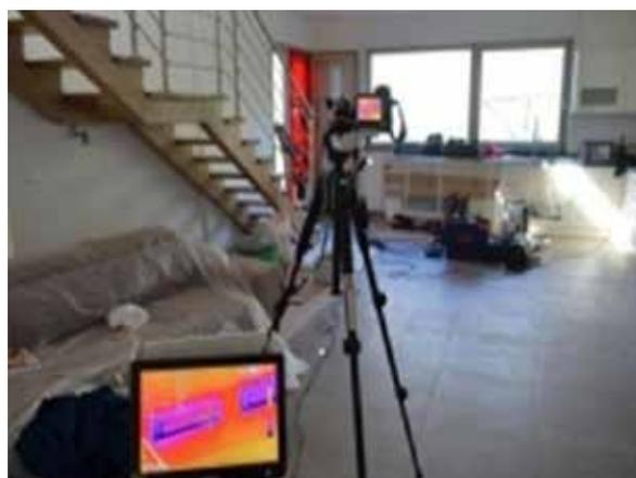
Dai test eseguiti in opera con temoflussimetri certificati e secondo la norma termica ISO 9869 nelle 72 ore, i valori termici del prodotto Bronya Facade risultano **corrispondenti** a quelli dichiarati dal produttore della DOP e **veritieri**.
